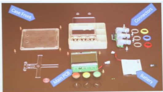
Neueste Generation der Steuereinheit des Elektrostimulationsgerätes für Senioren
